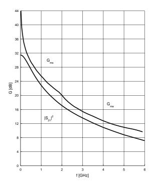
Power gain  $G_{ma}$ ,  $G_{ms} = f(V_{CE})$
