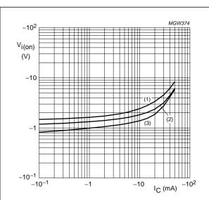
**TR2 (PNP);**  $V_{CE} = -0.3 \text{ V}.$
