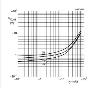
**TR2 (PNP);**  $V_{CE} = -0.3 \text{ V}.$
